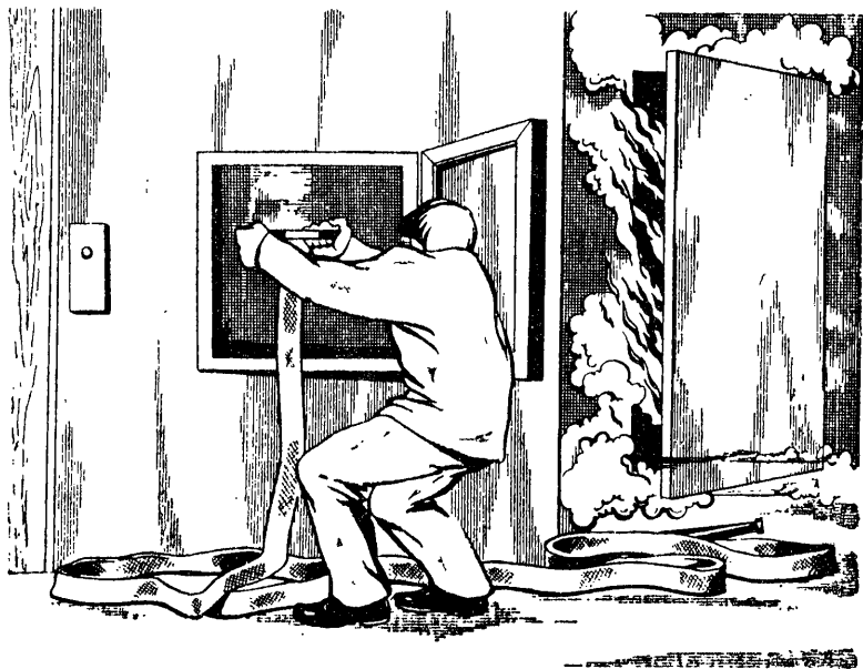
Рис. 20. Приведение в действие внутреннего пожарного крана
